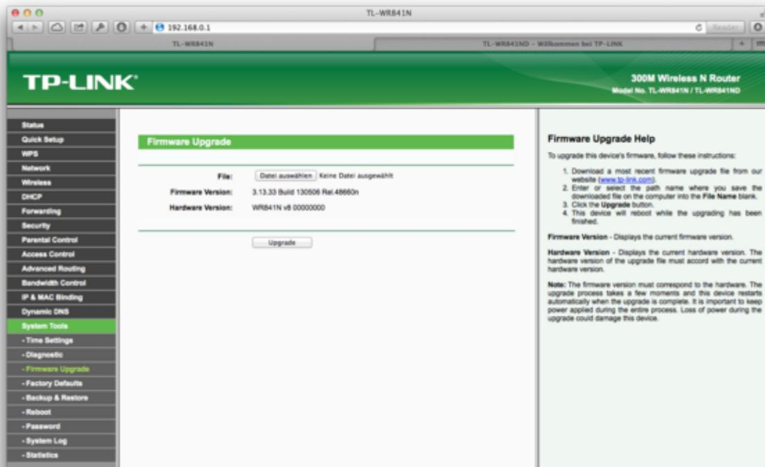
Über die Schaltfläche “Browse...” kannst Du nun die Firmware auswählen, die Du eben heruntergeladen hast. Nachdem Du bestätigt hast, dass die Firmware installiert werden soll, startet der Prozess. Trenne ab jetzt auf keinen Fall die Stromversorgung des Routers. Sonst schlägt die Installation fehl.
