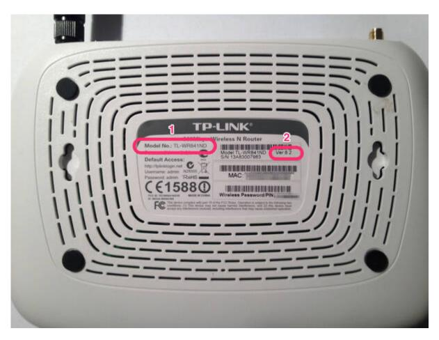
Wir unterstützten aktuell verschiedene Routermodelle. Zunächst musst Du prüfen, welche Firmware Du benötigst. Wichtig ist der Router-Typ (1) und die Hardware-Version (2). Beide Informationen findest Du auf der Rückseite Deines Geräts.
