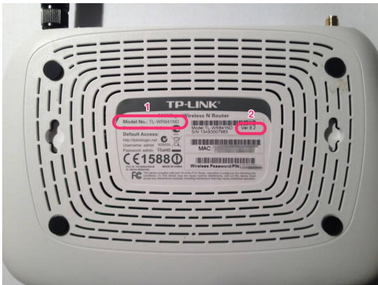
Wir unterstützen aktuell verschiedene Routermodelle. Zunächst musst Du prüfen, welche Firmware Du benötigst. Wichtig ist der Router-Typ (1) und die Hardware-Version (2). Beide Informationen findest Du auf der Rückseite Deines Geräts.
