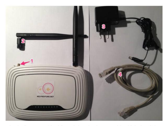
Schraube die Antennen (2) auf die Gewindestecker des Routers (1). Schließe danach den Router mit dem Netzteil (3) an eine Steckdose an. Anschließend verbindest Du den Router mit dem LAN-Kabel (4) mit Deinem Computer über eine der gelben Buchsen.
