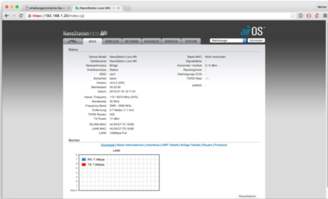
Die Hardwareversion des Gerätes befindet sich i.d.R. nicht auf der Verpackung, sondern ist nur direkt in der Weboberfläche erkennbar.
