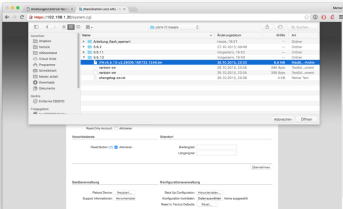
Anschließend musst du für das Downgrade der Firmware auf AirOS XM.v5.5.X / AirOS XW.v5.5.X auf den Button "Absenden" klicken.
